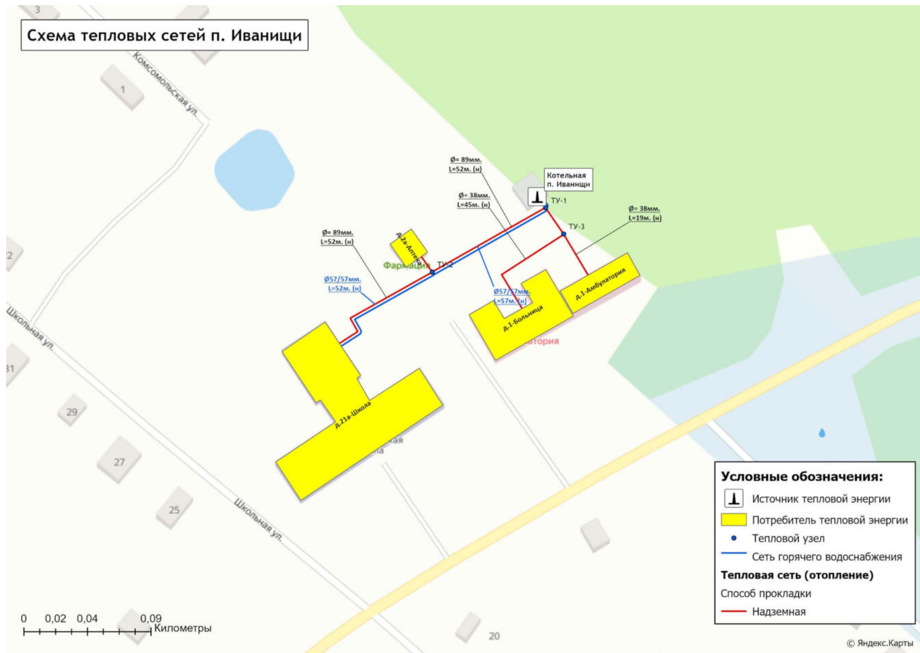
Рисунок 1.3.2.4 - Схема тепловых сетей котельной п. Иванищи
