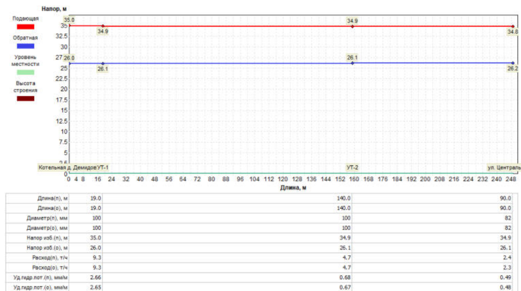
Рисунок 1.3.8.8 - Пьезометрический график участка сети «Котельная д. Демидово -> ул. Центральная, 13»
