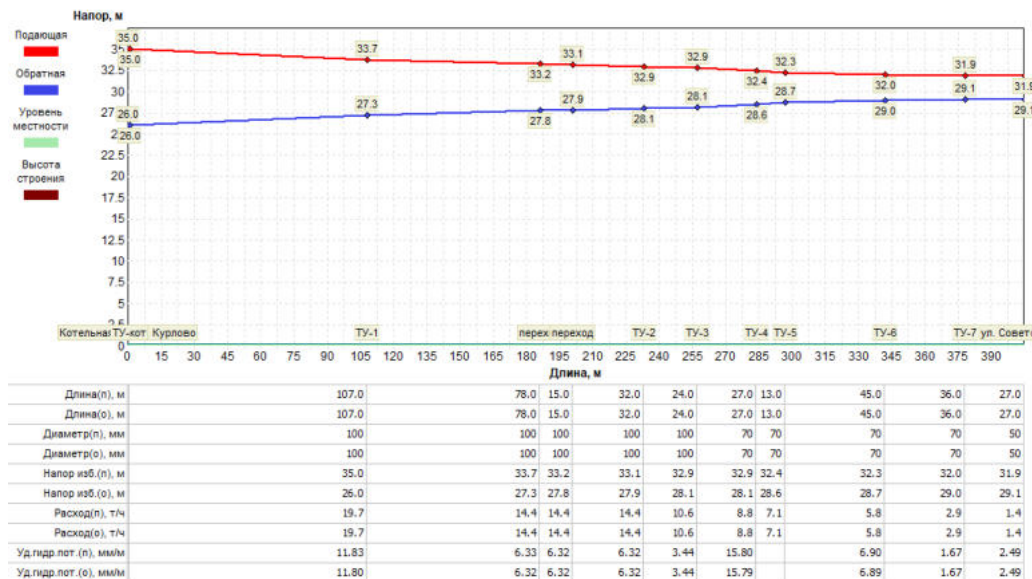
Рисунок 1.3.8.5 - Пьезометрический график участка сети «Котельная "ДК" г. Курлово -> ул. Советская, 12»
