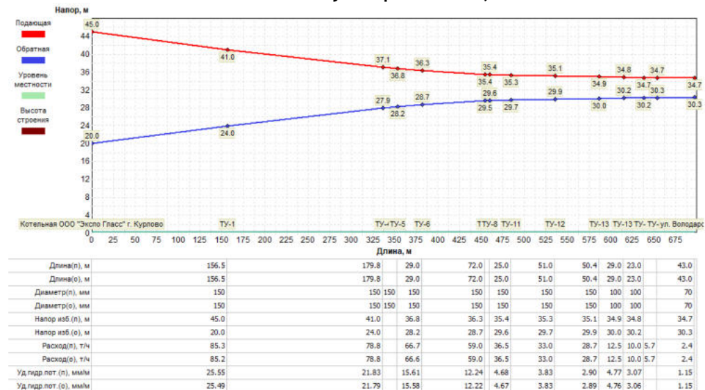
Рисунок 1.3.8.3 - Пьезометрический график участка сети «Котельная ООО "Экспо Гласс" г. Курлово -> ул. Володарского,1а»
